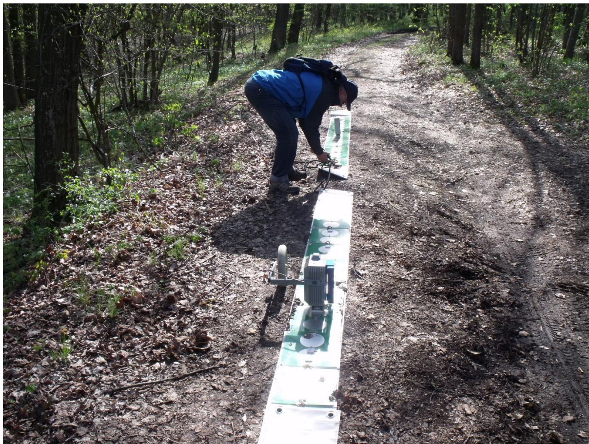
Obr. č. 2. Tento snímek nám ukazuje přípravu georadaru k akci nad jeskyní Pekárnou dne 23. dubna 2017. V tomto případě byly použity třímetrové antény v uspořádání „za sebou“.
