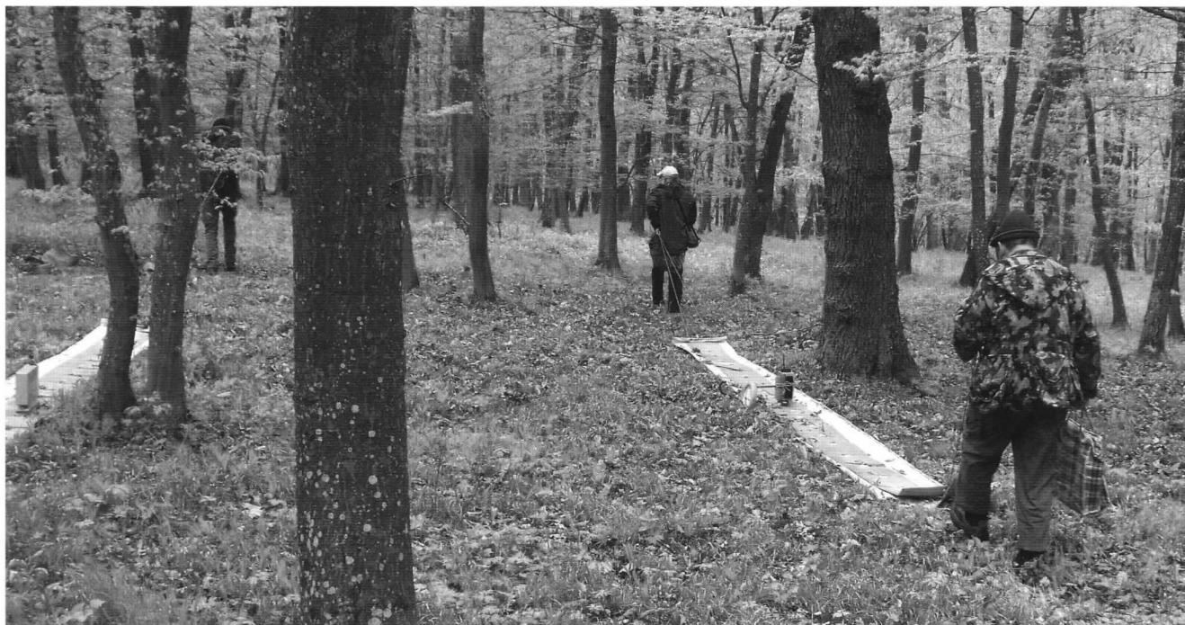
Obr. 5 Měření radarem nad Pekárnou 24. 4. 2016 – vlevo vysílač a anténa, vpravo přijímací anténa s přijímačem, měřením vzdálenosti na profilu a GPS (Foto J. Pokorný)
