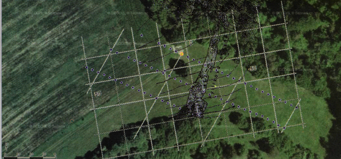
Obr. 2 Situace proměřovaných tíhových profilů a známých jeskyní (ortofotomapa Geodis) Fig. 2 Position of gravity profiles and known cave (orthophotomap by Geodis)
